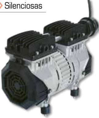
Cabezas compresoras de doble pistón. El bloque de cilindro está fabricado en hierro fundido, siendo así su durabilidad mucho mayor. Lubricación y fiabilidad óptimas siempre con reducido número de revoluciones. Total ausencia de pérdida de aceite. Intervalos de mantenimiento muy largos. Fabricado conforme a las más severas normas de seguridad tanto europeas como extra europeas.
